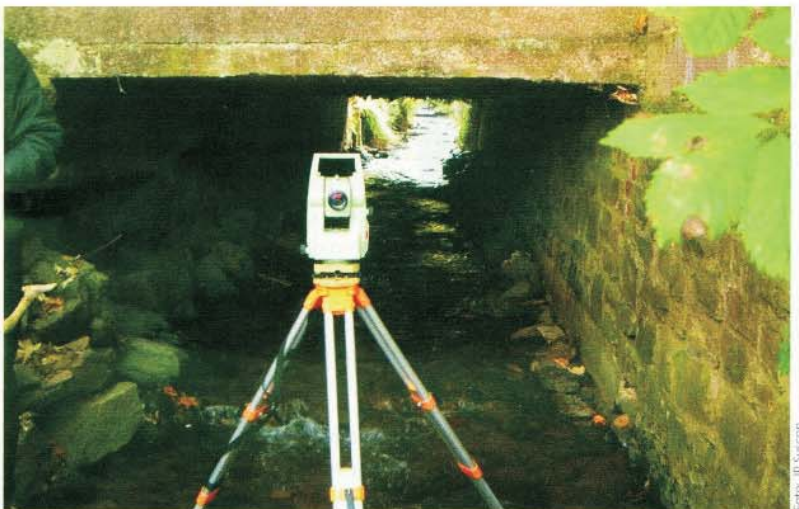
Vermessung auf schwierigem Terrain: Für die Hochwassersimulation müssen Höhen- daten etwa von Flussläufen genau erfasst werden.
